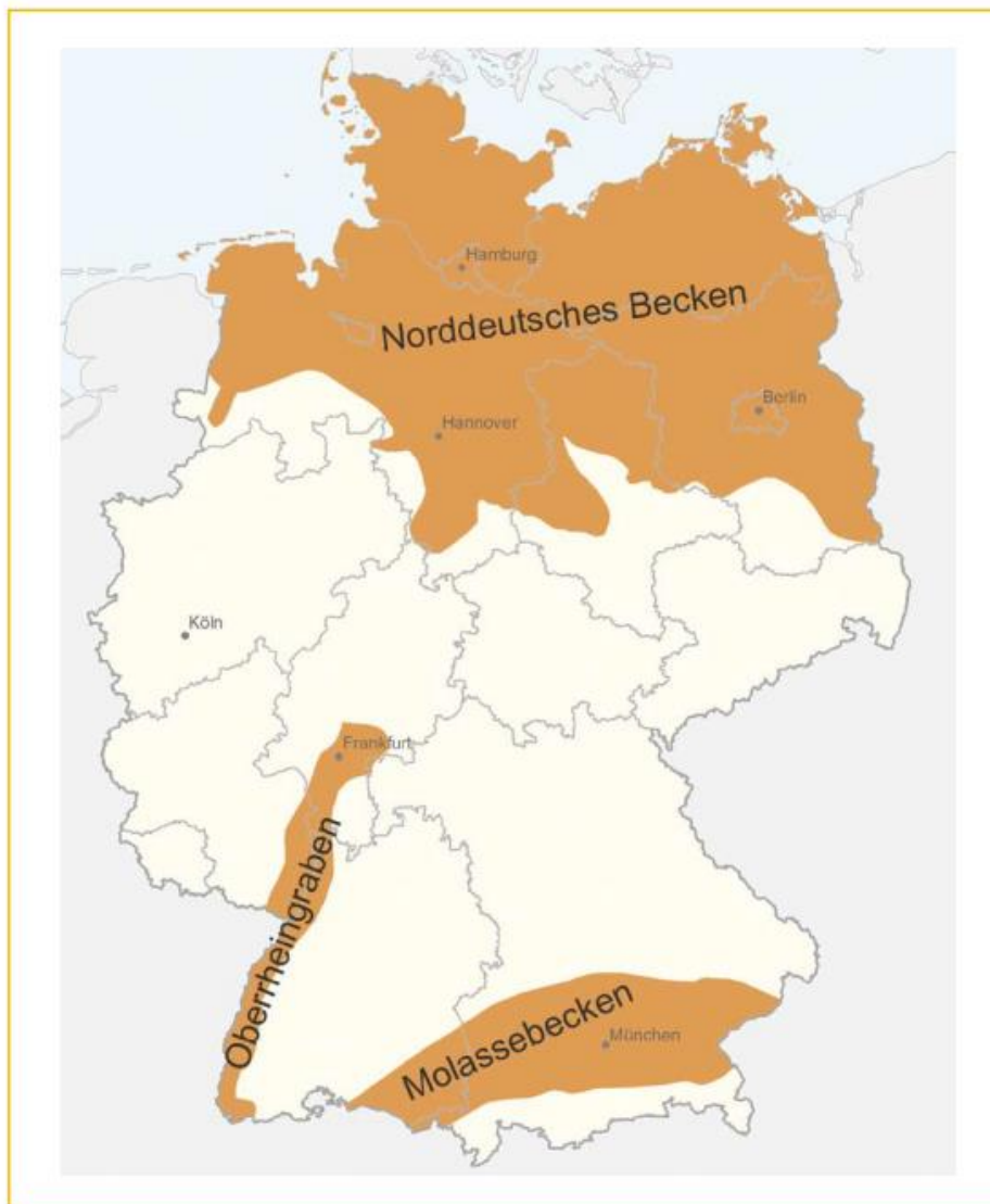
Abb. 28: Übersicht über die wichtigsten Regionen Deutschlands, die für hydrogeothermische Nutzungen in Frage kommen. Dargestellt sind Regionen, in denen Aquifere mit Temperaturen über 60 °C vorkommen (orange).
